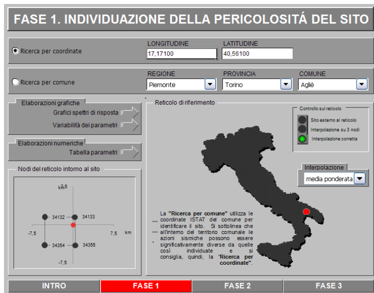
Figura 4.3.3.B – Localizzazione del sito oggetto di intervento (Azioni sismiche - Spettri di risposta ver. 1.03)
